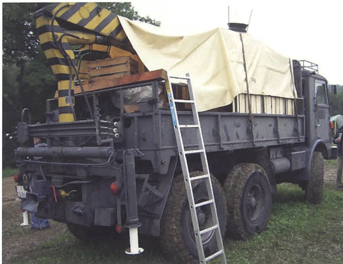
Für den Einsatz als Eichlastwagen bekam der SAURER 6CM eine feste 2CM-Ladebrücke und einen Heckkran.
