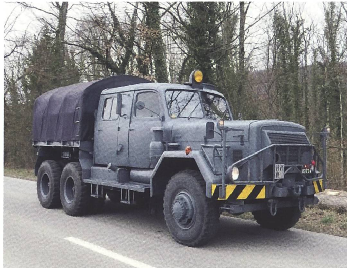
Der Magirus-Deutz Uranus sch gl 6x6 (Motor Diesel V12 luftgekühlt, 250 PS) war von 1956–1980 bei den Genie- und Panzertruppen als Zugfahrzeug für schwere Tiefbettanhänger, z.B. mit dem leichten Panzer AMX 13, 15 t, im Einsatz. Foto: militärfahrzeuge.ch
