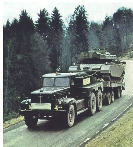
Rotinoff Super Atlantic GR7 6x4 (1958–1991): 8 Zylinder Rolls-Royce Reihenmotor, 16'200 cm 3 , 333 PS, Leergewicht 21.75 t. Mit diesem 300 cm breiten Schlepper wurden die 51 t schweren Centurion Panzer transportiert. Foto: militärfahrzeuge.ch
