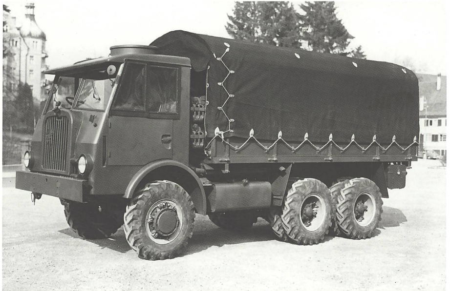
Prototyp Nr. 2 SAURER 6CM 6x6 1954, Chassis Nr. 20 560/2, CH2DR Motor Nr 85 092
