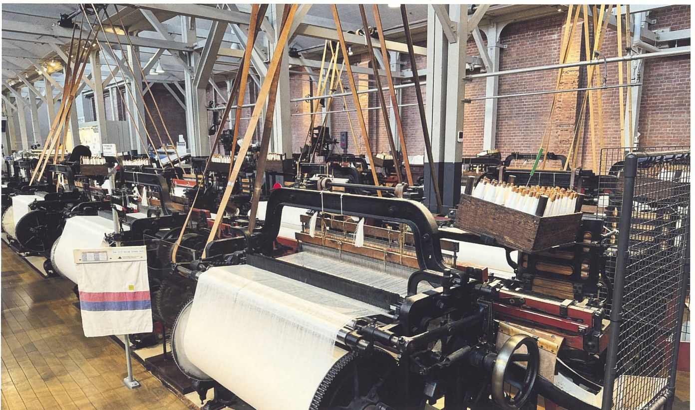
Webmaschinenaal mit automatischen Toyoda Webmaschinen Typ G.
