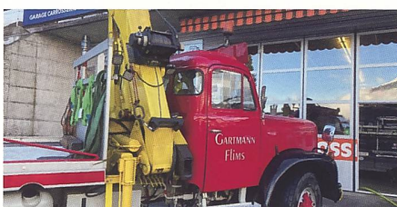
Bereits mit diesem Kran und Seilwinde ausgerüstet kommt der SAURER 5D von Carrosserie Chicherio nach Flims. Foto: Gion Item
