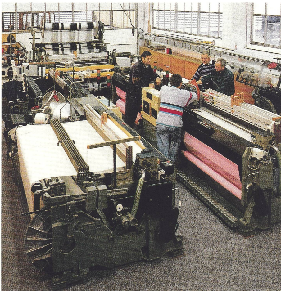
Teilansicht des Ausbildungszentrums in Arbon. Der Maschinenpark umfasste zwei S-500 Greiferwebmaschinen sowie eine Bandgreifer-Frottierwebmaschine Saurer 350 terry matic.
