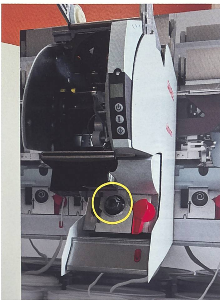
Die Spinnstelle. Links neben dem roten Handgriff ist gelb umrandet das Herzstück der Maschine, der Rotor, welcher das Garn verdreht.
