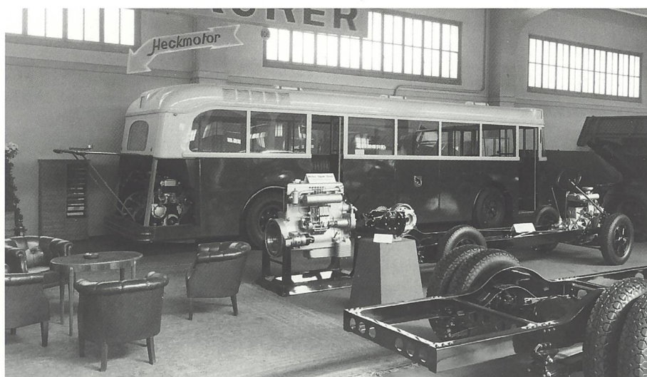
Eine neue Ära bricht an: Der in Zusammenarbeit mit dem SOB entwickelte neue Fahrzeugtyp hat statt einer langen Schnauze einen quer eingebauten Heckmotor. Autobus 45 wird am Genfer Automobilsalon 1939 am Stand von SAURER präsentiert. Quelle: Archiv Bernmobil
