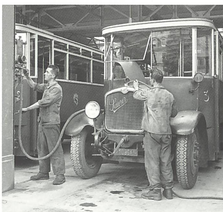
Zwei Garagearbeiter füllen in der Busgarage am Eigerplatz in Bern Benzin und Kühlwasser nach. (Autobus 2&3 des SOB, Saurer 4AD, ca. 1925) Quelle: Archiv Andreas Freiburghaus
