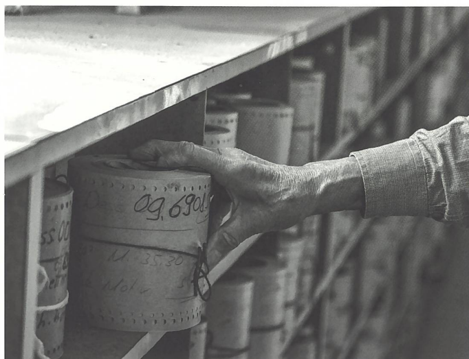
Kartenlager einer Automatenstickerei. In jeder Rolle ist ein Dessin gespeichert.
