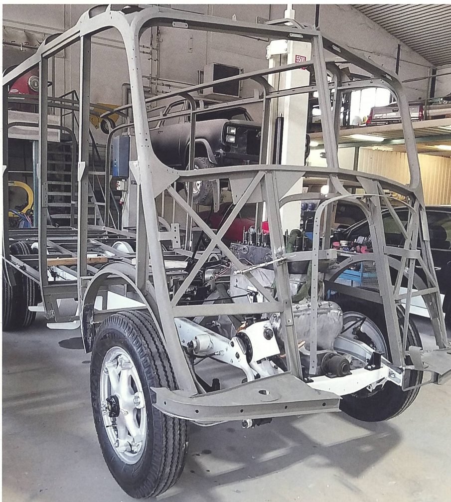
Das neu grundierte Gerüst harrt der Dinge
