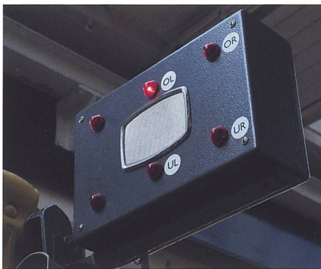
Die wieder funktionierende Elektronik des geretteten Fadenwächters. OL = oben links, OR oben rechts, UL unten links und UR unten rechts. Mit der entsprechenden Lampe wird angezeigt, in welchem Quadrant der Stickmaschine der Fehler passierte. Einfach und zweckmässig!
