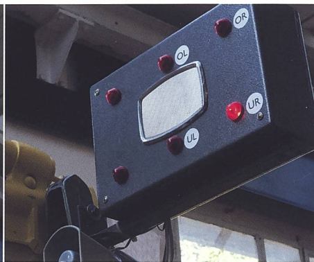
Die wieder funktionierende Elektronik des geretteten Fadenwächters. OL = oben links, OR oben rechts, UL unten links und UR unten rechts. Mit der entsprechenden Lampe wird angezeigt, in welchem Quadrant der Stickmaschine der Fehler passierte. Einfach und zweckmässig!
