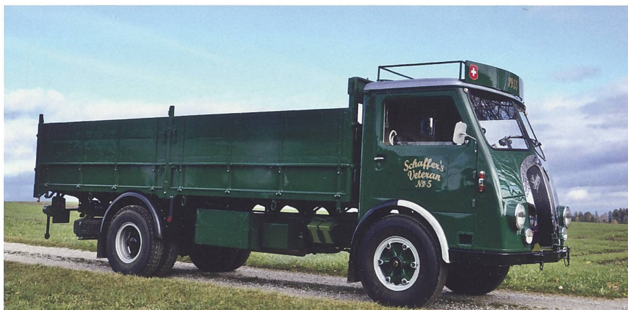
Wunderschön restauriert präsentiert sich der SAURER S4CH V8 im Herbst 2023. Motor CH2D mit 170 PS, Bremsen bei Revision umgebaut auf reine Druckluft, NOVA-Starter, 709'470 km.
