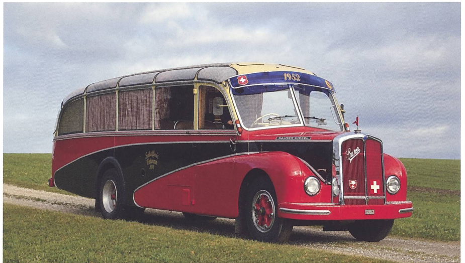
SAURER L4C 1952 mit dem Car alpin-Aufbau von Ramseier&Jenzer, weit nach hinten gezogenen Kotflügeln, eleganter rot-schwarz-roter Lackierung und in die Kotflügel integrierten Scheinwerfern.
