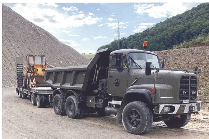
Der Saurer D330 6x4 Muldenkipper 1980 mit Tiefbettanhänger wird auch für Schwertransporte eingesetzt.
