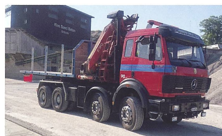
Der vielfältig einsetzbare Mercedes-Benz 3238 8x4-4 1992 (Ex Ölwehr TG) mit Hakengerät
