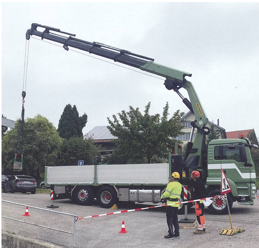
Ruedi im Training für die Kranprüfung im Herbst 2023 mit dem MAN TGS 35.540 8x2 2013 mit Kranaufbau Palfinger PK 53002 SH E
