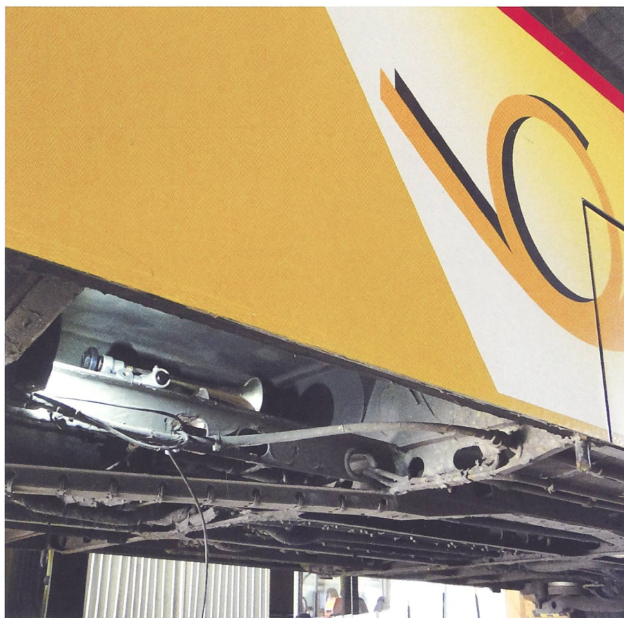
Das Dreiklanghorn befindet sich auf der Unterseite des Postautos.
