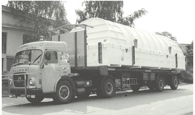
Saurer und FFA 1981 gemeinsam unterwegs für die Raumfahrt. Der überbreite FFA-Transportbehälter ist für die Nutzlastverkleidung der Ariane-Rakete konzipiert. Quelle: Staatsarchiv SG, W 241/5-810331
