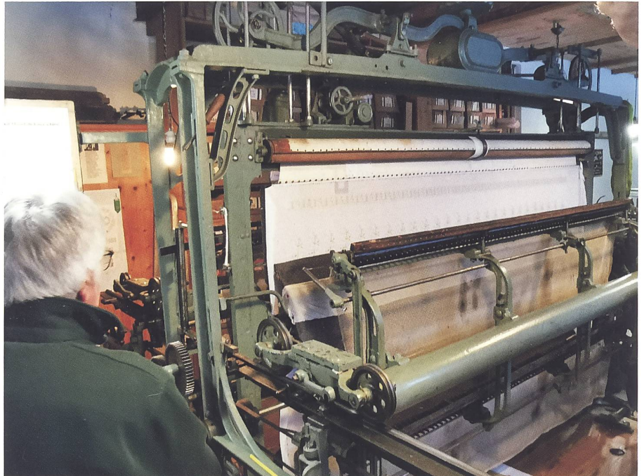
Die Saurer Handstickmaschine, auf welcher Bernhard Hollenstein heute noch täglich 4–5 Stunden stickt.
