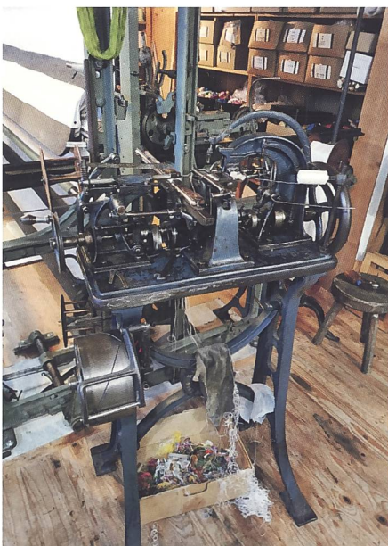
Die Fädelmaschine, die den Kinder das Fädeln abnahm
