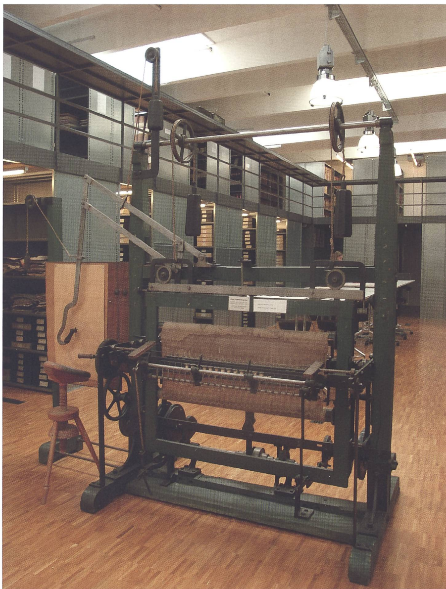
Vorderseite der ersten Schifflistickmaschine als Prototyp für die Durchführung praktischer Versuche. Konstruiert und gebaut in der 2. Jahreshälfte 1863 durch die Fa. Gebr. Benninger in Uzwil. Standort: Forster Rohner AG, St. Gallen, als Dauerleihgabe des Kulturmuseums St. Gallen. Aufgenommen 2013 von Martin Groebli.
