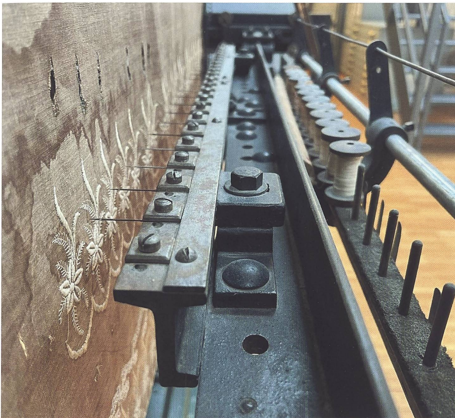
Nadelschiene der ersten Schifflistickmaschine. Konstruiert und gebaut in der 2. Jahreshälfte 1863 durch die Fa. Gebr. Benninger in Uzwil. Standort: Forster Rohner AG, St. Gallen, als Dauerleihgabe des Kulturmuseums St. Gallen. Aufgenommen 2023 von Emanuel Forster.
