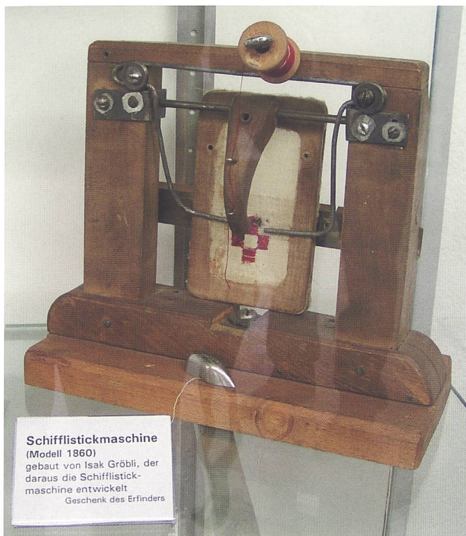
Schifflistickmaschine (Modell 1860) gebaut von Isak Gröbli, der daraus die Schifflistick- maschine entwickelt Geschenk des Erfinders Vorderseite des Funktionsmodells von Isaak Gröbli mit einer Nadel. Gebaut vom Erfinder bis Mitte 1863. Das später an das Modell gelegte Metallschiffli konnte für die Aufnahme nicht entfernt werden. Aufge- nommen 2015 von Heino Strobel durch die abgeschlossene Glasvitrine. Standort: Historisches Museum Arbon.
