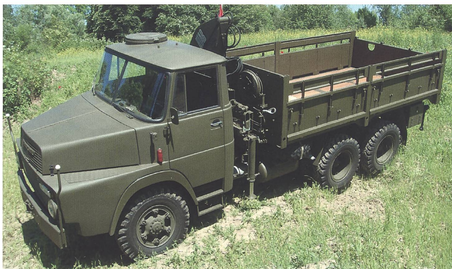
Henschel 7.3t gl 6x6 1970 mit hydraulischem Kran. Dieser Fahrzeugtyp wurde mehrheitlich bei der Artillerie und der Genie eingesetzt.
