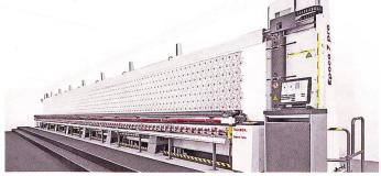
Schifflistickmaschine Saurer, Epoca 7.
