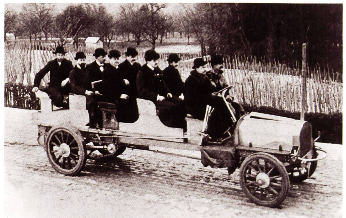
Der erste Saurer OLW 3TK Chassisnr. 2615/1 mit AM II-Motor Nr. 1452 für Motor Car Emporium (MCE) in London (GB) auf Probefahrt. Dieses Omnibus-Chassis wurde auch als «Char à banc» bezeichnet und war der Urahne aller späteren Saurer-Omnibusse! Foto: Werkbild Ad. Saurer AG Arbon, Nr. 623 (Aufnahme Januar 1905)
