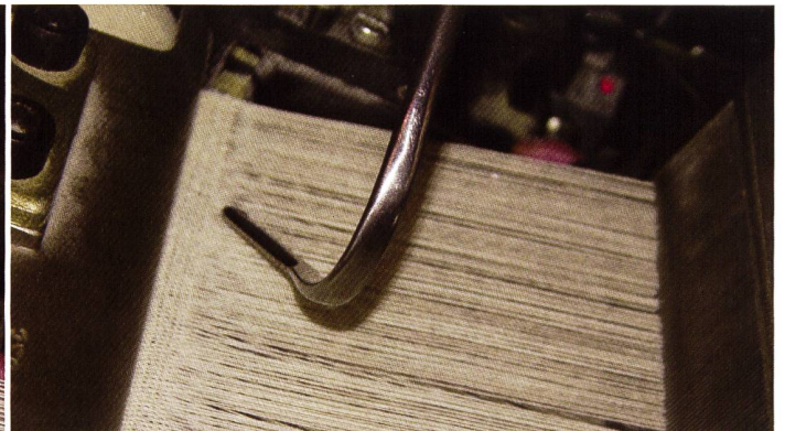
Die Abnehmerzange G bringt den Schussfaden zum Stoffanschlag (gemäss Skizze auf S. 10). Dort zieht die Einlegenadel das 15 mm lange Fadenschwänzchen ins Webfach.
