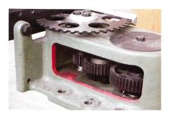
Oben: Oberes Getriebe des Greiferantriebes
