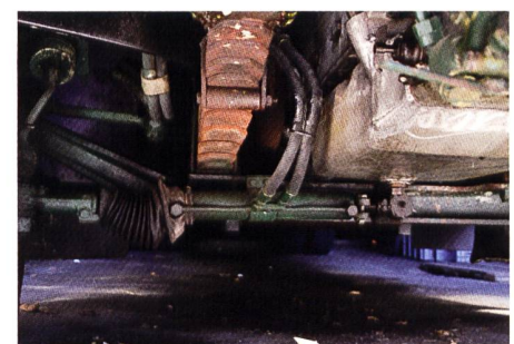
Andere Servolenkung: Beim BERNA ist der Lenkzylinder in der Spurstange eingebaut.
