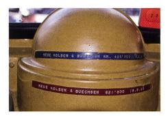
Etwa alle 400'000 km wurden Kolben und Büchsen ersetzt. Bei einer dieser Motorevisionen wurden 120mm Zylinderbüchsen eingebaut, wobei der Motor nun 180PS leistete.
