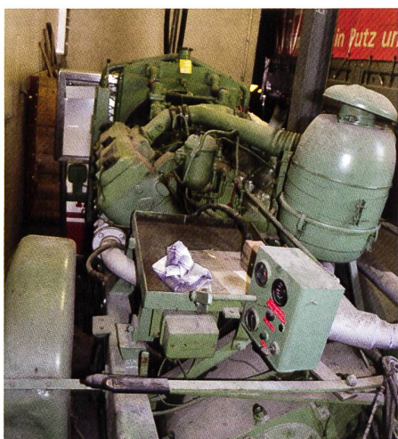
Dieser SAURER CH2D Motor wurde mittels einer SAURER Kardanwelle mit einer grossen Holzspaltmaschine gekuppelt.
