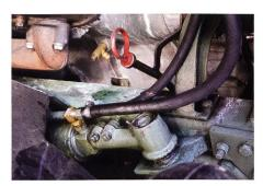
Bei den S4C Lastwagen kamen verschiedene Servolenksysteme zur Anwendung. Beim SAURER ist der Hydraulik-Lenkhilfzylinder am Lenkhebel eingebaut.
