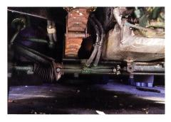
Andere Servolenkung: Beim BERNA ist der Lenkhilfzylinder in der Spurstange eingebaut.
