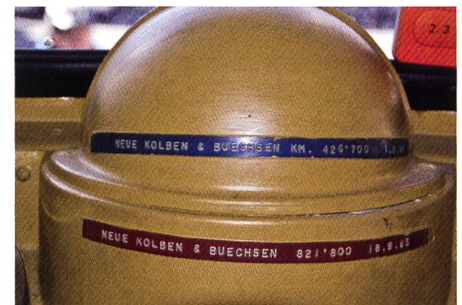
Etwa alle 400'000 km wurden Kolben und Büchsen ersetzt. Bei einer dieser Motorevisionen wurden 120mm Zylinderbüchsen eingebaut, wobei der Motor nun 180PS leistete.
