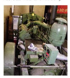
Dieser SAURER CH2D Motor wurde mittels einer SAURER Kardanwelle mit einer grosse Holzspaltmaschine gekuppelt.
