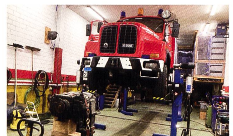
Saurer D230 auf Hebebock, ZF-Getriebe
