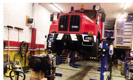
Saurer D230 auf Hebebock, ZF-Getriebe
