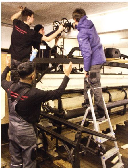
Start der Demontage (Pantograph und Gegengewichte)
