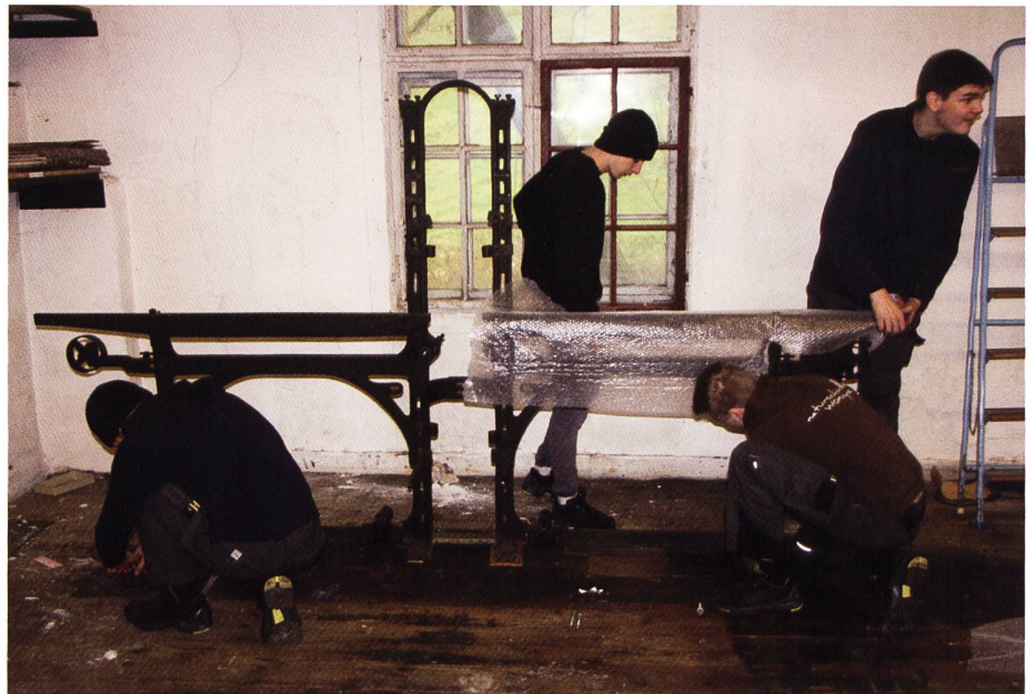
Letztes Teil, ein Schild, wird vom alten Hallenboden gelöst und die Führungsbahnen zum Schutz abgedeckt.
