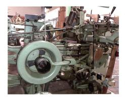
Das vom Motor angetriebene Schwungrad und das Gestänge für die Betätigung der Lamellenkupplung. Rechts oben der Starthebel.
