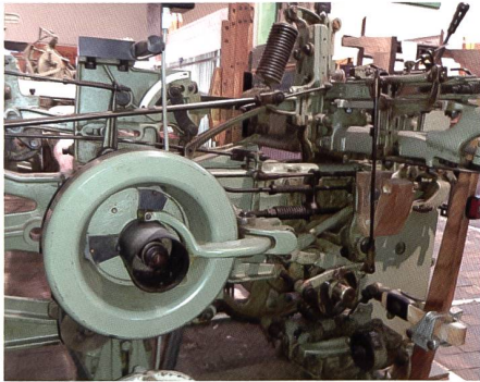
Das vom Motor angetriebene Schwungrad und das Gestänge für die Betätigung der Lamellenkupplung. Rechts oben der Starthebel.
