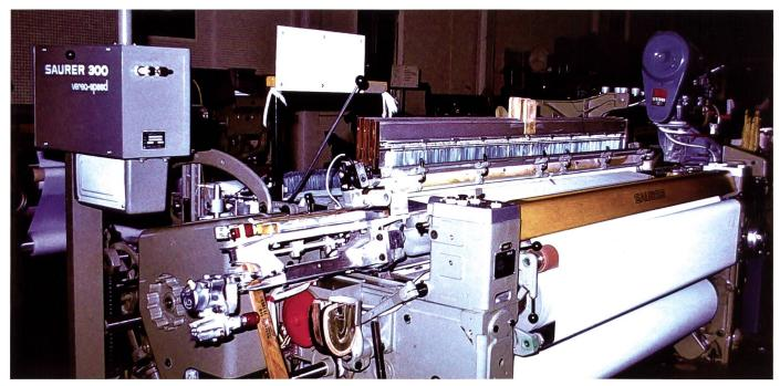
Die S300 von der Antriebseite her. Der Antrieb ist vollständig verschalt, nur das Handrad schaut heraus. Daneben sichtbar der rote Zentralschalter. Der Steuerkasten steht zur Vermeidung von Vibrationen neben der Maschine.
