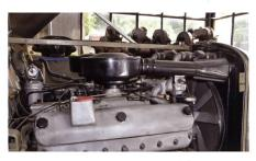
Der CH5D V8 Motor mit 180 PS (gi)
