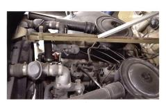
V8- Bauweise, man beachte: 2 Luftfilter, 2 Thermostaten, Doppelkompressor, Einspritzpumpe mit 8 Elementen (ai)
