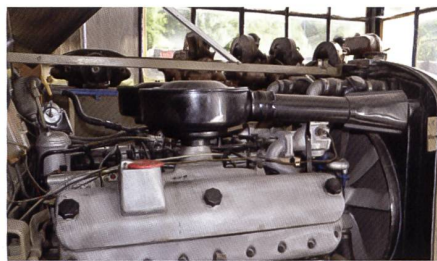
Der CH5D V8 Motor mit 180 PS (gi)
