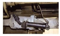
Die Oetiker-Motorbremse wird im hinteren Auspuffstrang eingebaut. Mit dem Absatz bedient man einen Druckknopf. Mittels Druckluft wird im Auspuffstrang eine Klappe geschlossen, was eine sehr gute Bremswirkung ergibt, wie sich das Autorenteam selber ein Bild machen konnte. (gi)
