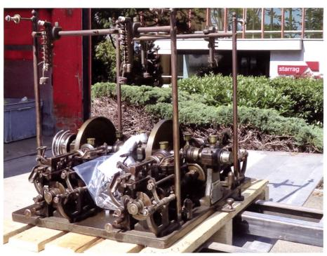
4-fach Bobinenmaschine mit Reibrad-Antrieb
