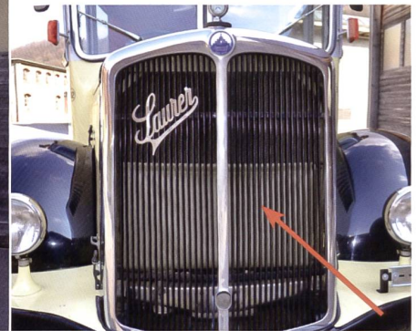
Kühlergrill mit halb geschlossenem Rouleau im L4C 1948 von HNF Benken/Ziegelbrücke.
