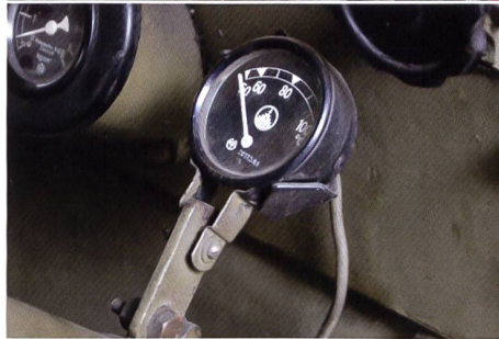
Ganz rechts: Sowohl die ADL N4C 1951 der Stadt St. Gallen wie der BLD 1932 Brauerei Schützengarten haben einen AMOS-Thermostat. Links oben: AMOS-Thermostat, waagrecht eingebaut in der ADL N4C 1951 Rechts oben: BLD 1932 Brauerei Schützengarten (Depot) Rechts: Original SAURER-Temperaturanzeige im Schützengarten BLD 1932 (Depot)
