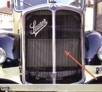
Oben: Das Motorkühlsystem im SAURER L4C 1948 (Historische Nutzfahrzeuge HNF Jürg Biegger Benken/ Ziegelbrücke): AMOS-Thermostat und mechanische Temperaturreglung mit Kühlerrouleau.
