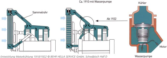
Motor in Betrieb ist, läuft der Kühlkreislauf. Die Wasserpumpe kommt ca. 1910 dazu und unterstützt nun die Wasserzirkulation. Eine Regelung ist nicht möglich, was zu einer langen Warmlaufzeit und im Winter zu niedriger Motortemperatur führt.
