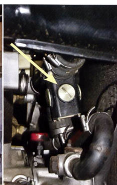
Links: In vielen Schauenpostautos dürfte der AMOS-Thermostat inzwischen durch modernere ersetzt worden sein. Nicht so im L4C 1949 29 Plätze (von Bodenseereisen Kurt Baumgartner Horn). Rechts: AMOS-Thermostat im L4C
