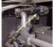
Oben: Zusätzlich zum AMOS-Thermostat und einem Kühlerrouleau wurde bei diesem 4C 1941 der Brauerei Schützengarten eine Kühlerabdeckung aus Leder montiert.
