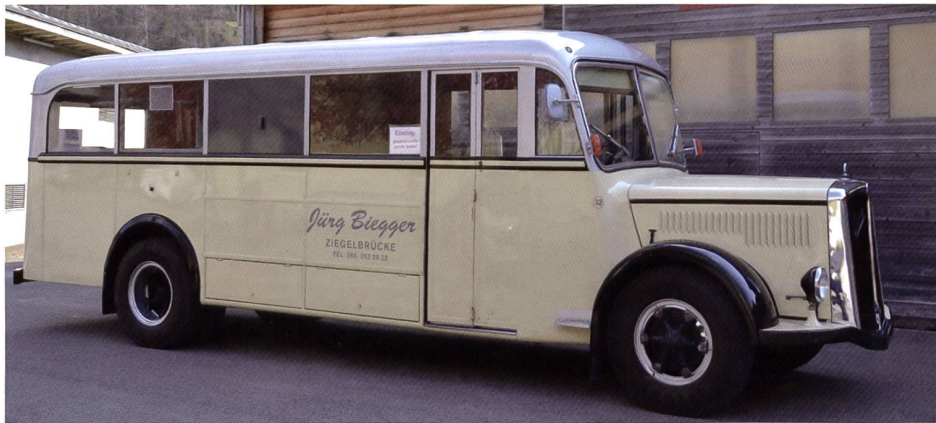
Kühlergrill mit halb geschlossenem Rouleau im L4C 1948 von HNF Benken/Ziegelbrücke.
