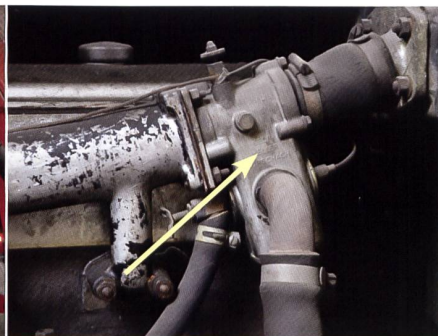
Links: In diesem Armee-SAURER BLD 1935 (im Depot) wurde der AMOS-Thermostat wie in vielen anderen Fahrzeugen nachträglich eingebaut. Oben: AMOS-Thermostat im Armee BLD 1935
