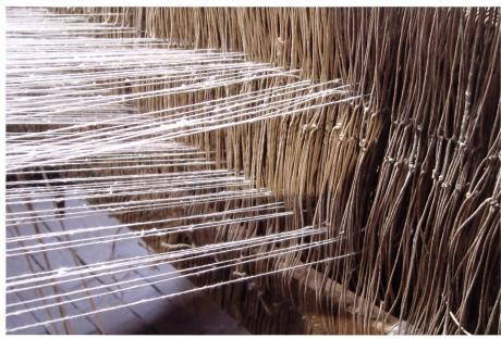
Fachbildung durch die gehobenen und gesenkten Kettfäden
