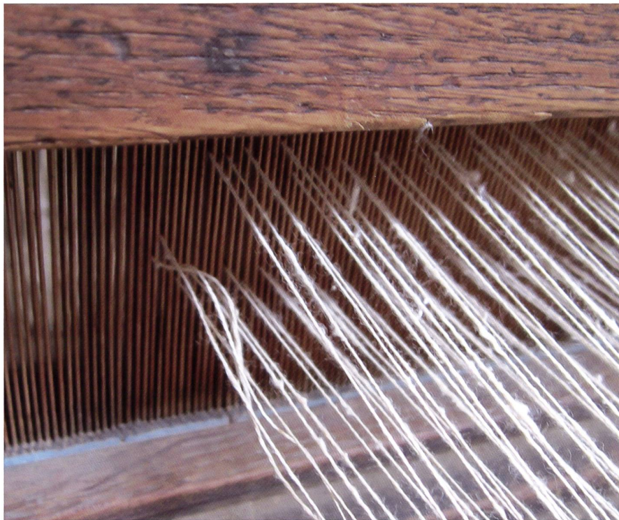
Das Webblatt aus geschnittenem Schilfrohr
