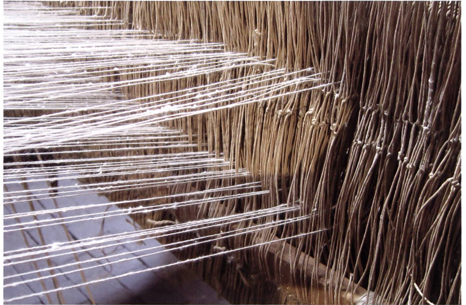
Fachbildung durch die gehobenen und gesenkten Kettfäden
