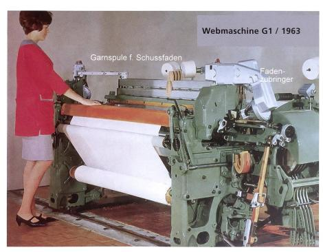
Bild 1: Webmaschine G1 / 1963 im Versuchsbetrieb
