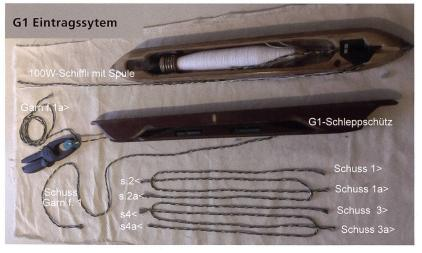
Bild 3: oben der gerade Fadeneinzug mit dem alten Schützen, unten der raffinierte Fadeneinzug mit dem neuen Schützen
