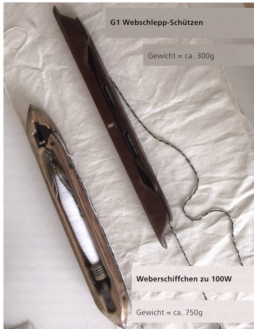
Bild 2: oben der neue, leichtere und doch robuste Webschütz (Schiffchen), unten der bekannte Schütz aus der 100W mit dem doppelten Gewicht
