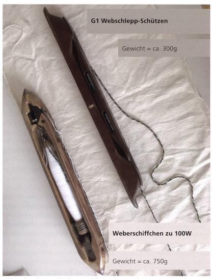
Bild 2: oben der neue, leichtere und doch robuste Webschütz (Schiffchen), unten der bekannte Schütz aus der 100W mit dem doppelten Gewicht
