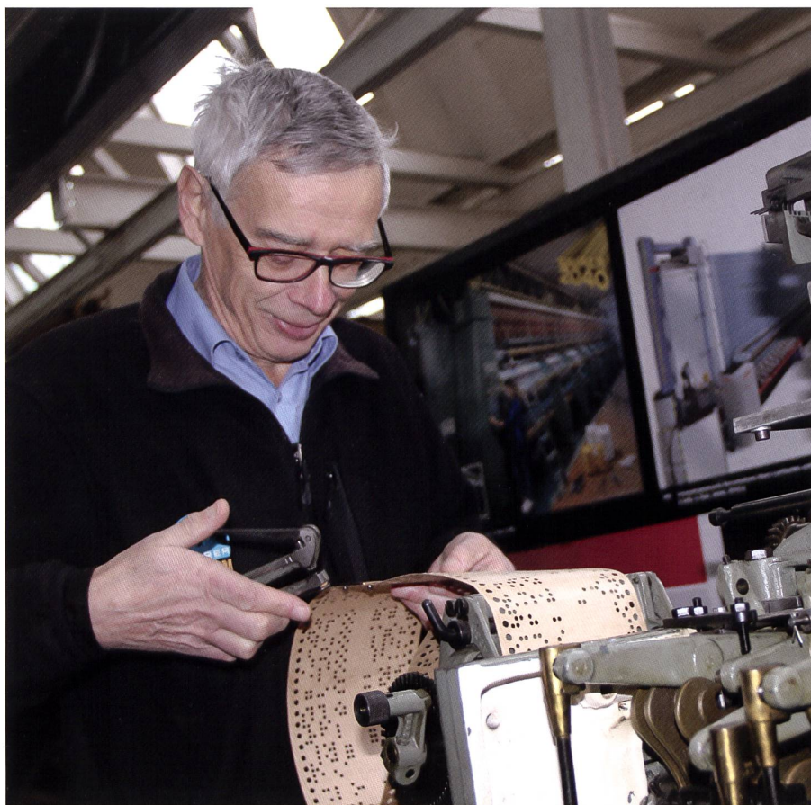
Ruedi Rüegger kontrolliert den Lochstreifen am Stickautomaten.
