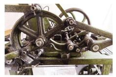
Koppeltrieb-Kurbelschwinge an der Levy-Maschine
