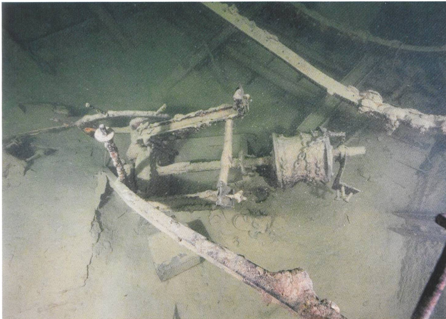
Steuerruder, Kraftübertragung vom Rad auf das Ruder
