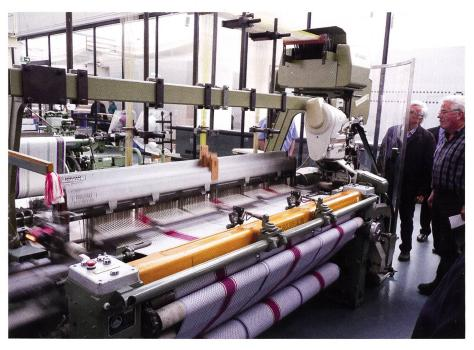
Saurer 300 Webmaschine mit elektrischer Drucknopf-Bedienung, mit Unifil-Spulenautomat, ausgestellt im TIM Augsburg.
