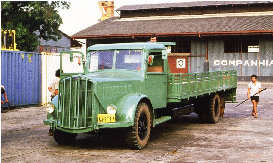
Dieser SAURER 3C 4.5t wurde in Belém total restauriert. Dabei wurde der Radstand verlängert und eine brasilianische Holzladebrücke montiert.
