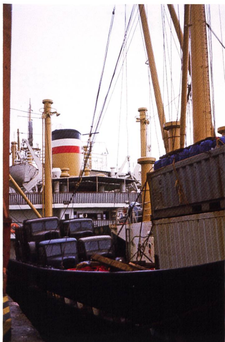
Aufeinander gestapelt treten die Lastwagen den Weg über den Atlantik nach Brasilien an. Während der Überfahrt sind sie Wind und Wetter ausgesetzt, was aufwendige Korrosionsschutzmassnahmen notwendig machte.
