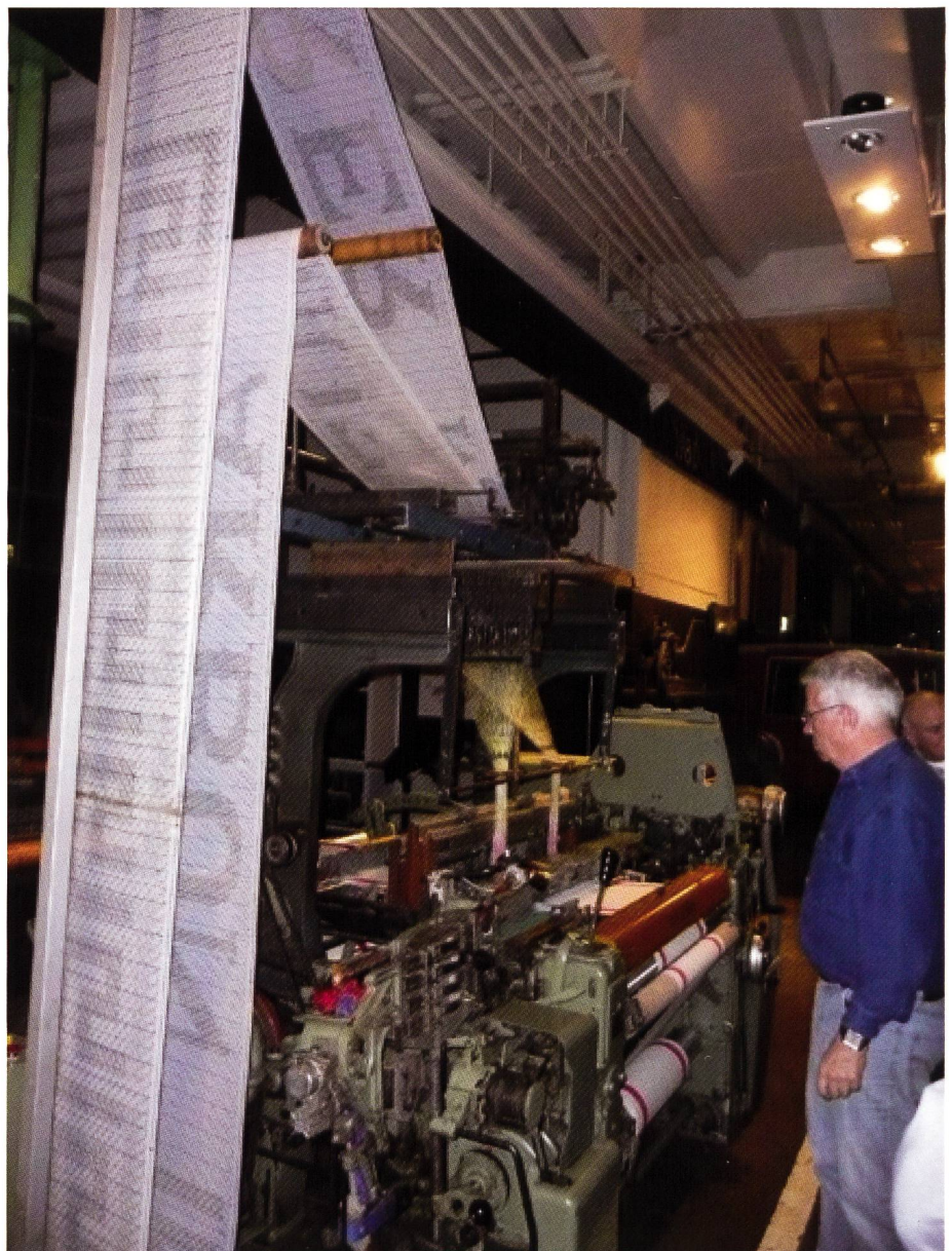
100W Tüchlimaschine Nr. 63'891 von 1978 mit aufgebauter, lochkartengesteuerter Stäubli-Nameneinwebmaschine
