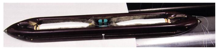
Der spezielle zweifach bestückte Webschütz («Schiffchen»)
