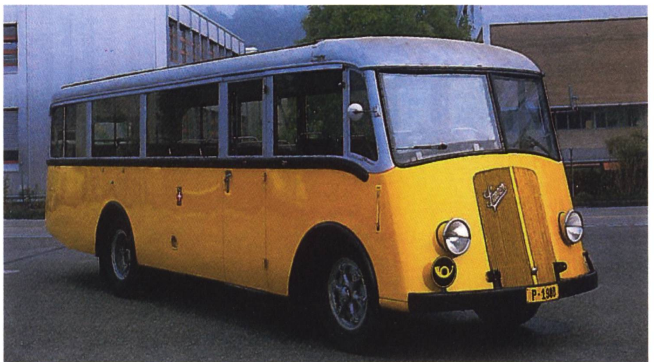
Der P1980 ist der älteste Frontlenker in der Sammlung des PTT-Museums. Der vom Saurer-Konstrukteur Deiters gebaute und patentierte Prototyp P1980 wurde in einer für die damalige Zeit revolutionären Bauweise hergestellt. Es blieb beim Prototyp. Der Siegeszug der Frontlenker begann erst in den 50er Jahren mit dem Einsatz der Unterflurmotoren.
