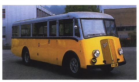
Der P1980 ist der älteste Frontlenker in der Sammlung des PTT-Museums. Der vom Saurer-Konstrukteur Deiters gebaute und patentierte Prototyp P1980 wurde in einer für die damalige Zeit revolutionären Bauweise hergestellt. Es blieb beim Prototyp. Der Siegeszug der Frontlenker begann ers in den 50er Jahren mit dem Einsatz der Unterflurmotoren.
