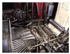
Die Lochkarte wird von diesem Nadelsystem abgetastet
