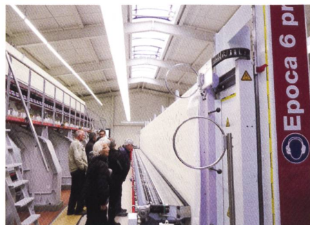
Unica Stickmaschine (zweistöckig), und eine Epoca 6 pro
