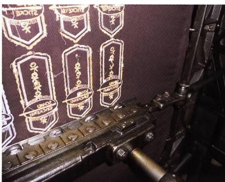
Die Schiffli auf der Hinterseite bewegen sich horizontal und sind daher sehr kurz
