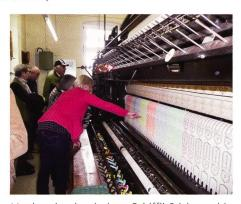
Vorderseite der riesigen Schiffli-Stickmaschine VOMAG von ca. 1910
