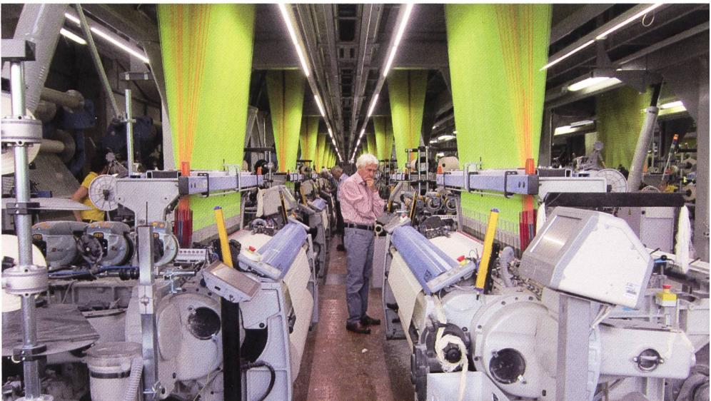
*Im Vergleich: Die leistungsstärkste unserer Museumsmaschinen bringt es auf 300 Schuss/min. aber auf zwei Gewebebahnen. Das heisst, die SAURER 500 Zweiphasen-Greiferwebmaschine war vor gut 30 Jahren schon auf einem beachtlichen Leistungsniveau. Bekanntlich hatte der im Jahr 1986 getroffene «Webmaschinen Entscheid», zur Aufgabe der Webmaschinen Produktion geführt.*
