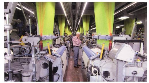
Im Vergleich: Die leistungsstärkste unserer Museumsmaschinen bringt es auf 300 Schuss/min. aber auf zwei Gewebebahnen. Das heisst, die SAURER 500 Zweiphasen-Greiferwebmaschine war vor gut 30 Jahren schon auf einem beachtlichen Leistungsniveau. Bekanntlich hatte der im Jahr 1986 getroffene «Webmaschinen Entscheid», zur Aufgabe der Webmaschinen Produktion geführt.
