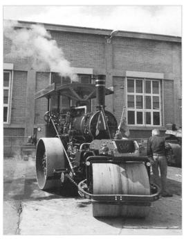
SLM Strassendampfwalze 1923 der Firma Toller & Loher, 2013 sogar im Aktiveinsatz beim Belagseinbau der Seestrasse in Meilen
