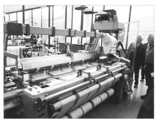
Eine Saurer 300 mit Druckknopfbetätigung. Mit den steigenden Drehzahlen wurde es immer schwieriger, die Maschinen mit dem Handhebel sicher zu Starten und zu Stoppen. Die Maschine webt immer noch mit einem Webschützen, hat aber eine elektromagnetische Kupplung / Bremse. Anstelle eines Spulenmagazins ist sie ausgerüstet mit einem Unifil-Spulautomaten. Die Schussspulen werden direkt auf der Webmaschine gespult.
