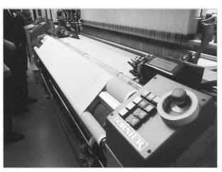
Auch von Dornier, einem der schärfsten Konkurrenten von Saurer, ist eine moderne Greifer-Frottierwebmaschine ausgestellt.
