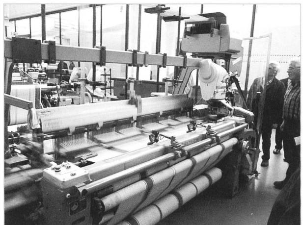
Eine Saurer 300 mit Druckknopfbetätigung. Mit den steigenden Drehzahlen wurde es immer schwieriger, die Maschinen mit dem Handhebel sicher zu Starten und zu Stoppen. Die Maschine webt immer noch mit einem Webschützen, hat aber eine elektromagnetische Kupplung / Bremse. Anstelle eines Spulenmagazins ist sie ausgerüstet mit einem Unifil-Spulautomaten. Die Schussspulen werden direkt auf der Webmaschine gespult.
