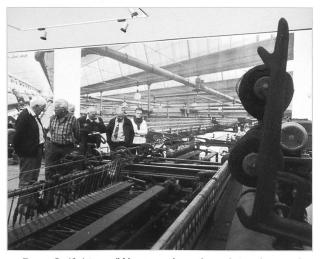
Der Selfaktor (Wagenspinner) zeigt einen der Schritte zur mechanischen Erzeugung des Garnes. Er arbeitet diskontinuierlich, das heisst man musste nach einigen Metern Garn wieder neu ansetzen. Diese Arbeitsweise ist dem Spinnen von Hand nachempfunden. Später realisierte man den kontinuierlichen Spinnprozess.
