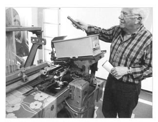
Hier ein 100W Webstuhl mit Kastenlader für die Spulenzufuhr. Man versuchte den Personalaufwand für das Beschicken der Webstühle mit Schussspulen einfacher und rationeller zu gestalten. So ersetzte man etwa 1965 das Trommelmagazin durch diesen Kasten.
