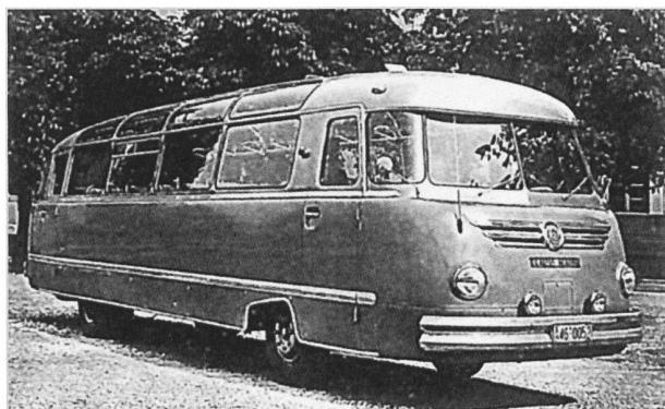
Der Omnibus hat in den folgenden 20 Jahren bei KM eine grosse Rolle gespielt und der Einführung des Heckmotors folgten noch weitere Innovationen, die später zum Allgemeingut im Omnibusbau wurden. (Saurer baute ja in den 30er Jahren bereits einen Prototyp mit Heckmotor). So verwendete Krauss Maffei bereits auch das von Voith gebaute DIWABUS-Getriebe 200.
