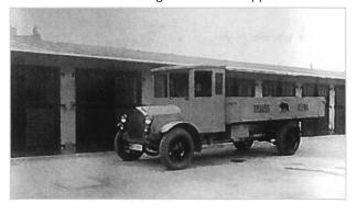
ständig beabsichtigt, so wurde der Wagen mit einem Motor geliefert, welcher 115 mm Bohrung und 160 mm Hub hatte. Die Leistung betrug dann 50 PS und der Benzinverbrauch reduzierte sich von 48 auf 42 - 38 Liter
