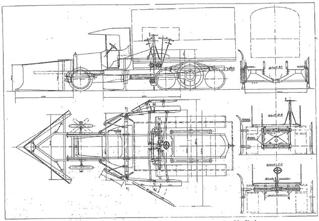
Abb. 10. Der neue Pflugwagen mit Stosspflug und verstellbaren seitlichen Pflugflügeln.
