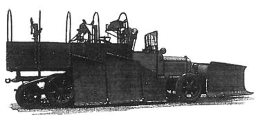
Neben dem Fübrersitz den ersten, festen Pflugflügel und dahlinter den grossen, doppelteiligen und verstellbaren Pflugflügel. Auf der Wagenbrücke sind die Handräder für die Pflugflügelverstellung, Kranen. Reservebenzinbehälter usw. sichthar.
