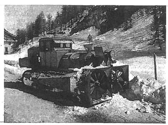
Daneben die Benzinbehälter. Seitlich das Raupenband und die Verschalung der Antriebswelle für die Schaufelräder,
