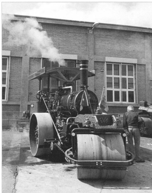
SLM Strassendampfwalze 1923 der Firma Toller & Loher, 2013 sogar im Aktiveinsatz beim Belageinbau der Seestrasse in Meilen
