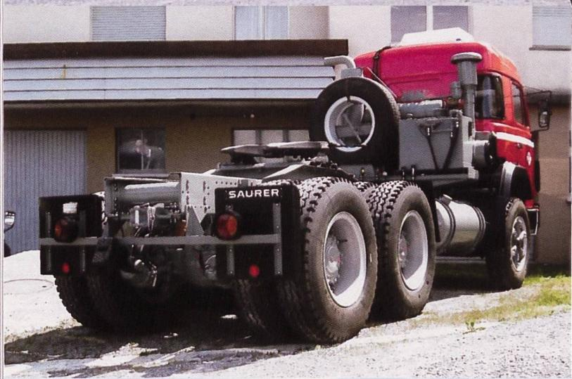
Rechts: Saurer D330 F6x4 Sattelschlepper, Chassisnr. 209123, Motor D4KC Nr. 109909 mit Druckwellen-Aufladung Comprex von BBC, 1. Inverkehrsetzung 20. Januar 1978 bei Brown-Boveri + Cie AG (BBC) in Baden/AG, heutiger Besitzer Walter Mühlé Wolfhausen/ZH
