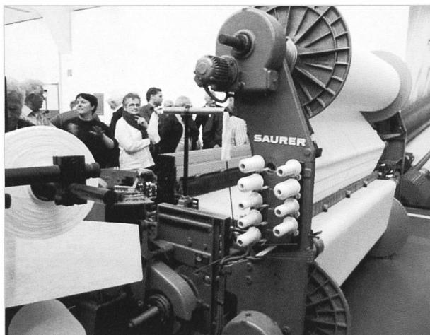
Pol- und Grundkettenbaum werden mit elektronisch gesteuerten geschlossenen Getrieben abgewickelt, das ergibt einen einfachen Aufbau, vereinfacht die Wartung und erleichtert die Bedienung.
