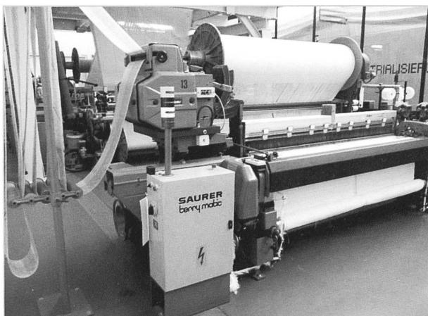
Saurer übernahm 1971 die Firma Diederichs, welche eine Greiferwebmaschine entwickelt hatte. Die bewährte Saurer Frottier-Einrichtung wurde darauf aufgebaut. Das ergab die Terry-Matic. Die Maschine hat eine sehr hohe Schusseintragsleistung.
