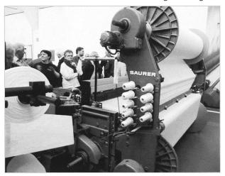
Pol- und Grundkettbaum werden mit elektronisch gesteuerten geschlossenen Getrieben abgewickelt, das ergibt einen einfachen Aufbau, vereinfacht die Wartung und erleichtert die Bedienung.
