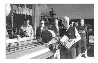
Hans Stacher setzte nun die Maschine in Betrieb und erklärte die Entstehung des Frottierstoffes. Das Grundgewebe wird wie auf einer gewöhnlichen Schützen-Webmaschine gewoben. Für die Polnoppen braucht es viel mehr Material von einem zweiten Kettbaum, welcher deshalb grösser als der Grundkettbaum ist.
