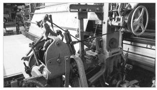
Für die Bildung der Noppen dient der Frottierapparat. Dieser schaltet die Polkette über die Förderwalze. Er steuert zudem die Zughaken, welche beim ersten und zweiten Schuss die Weblade zurückhalten.
